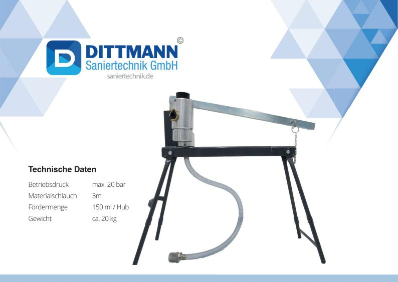
Die Niederdruckpumpe ND 150 ist eine manuell betriebene HandhebelKolbenpumpe für das Fördern, Verfüllen und Injizieren von wässrigen und mineralischen, pumpfähigen Medien bis max. 0,3 mm Korngröße.
